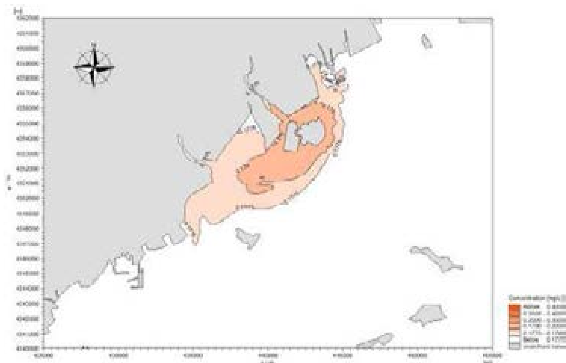
图 4.3-2 无机氮的浓度包络线
